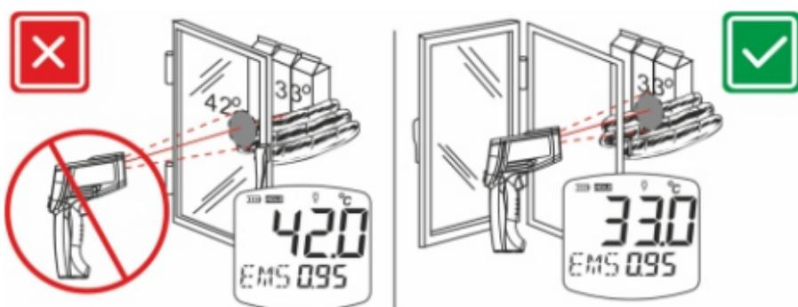
Прибор не может измерить температуру объекта находящегося за прозрачным или полупрозрачным препятствием, например: стекло, пар, дым и т.д. – он будет измерять температуру этого препятствия
