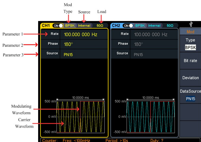
Рисунок 26 - Интерфейс задания настроек BPSK
