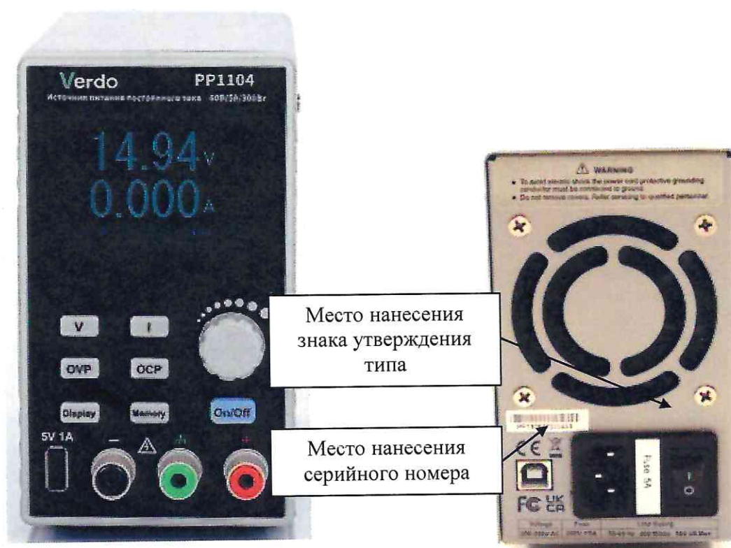
Рисунок 1 – Общий вид источников серии VERDO PP1100 с указанием места нанесения знака утверждения типа, места нанесения серийного номера
