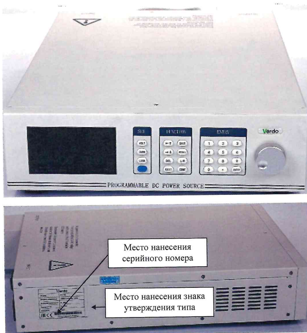
Рисунок 2 – Общий вид источников серии VERDO PP1700 с указанием места нанесения знака утверждения типа, места нанесения серийного номера
