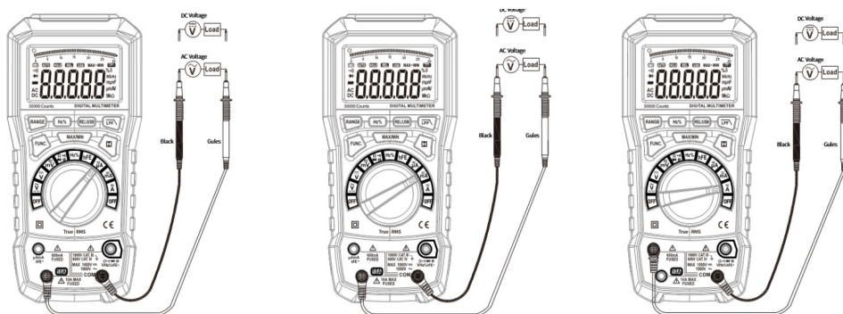
Рисунок 10 - Измерение постоянного и переменного тока
