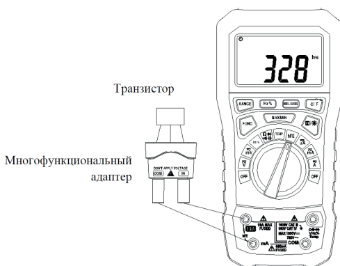
Рисунок 13 - Измерение коэффициента усиления транзистора (hFE)
