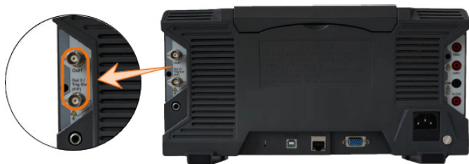
Рисунок 70 - Выходные порты генератора (двухканальные)
