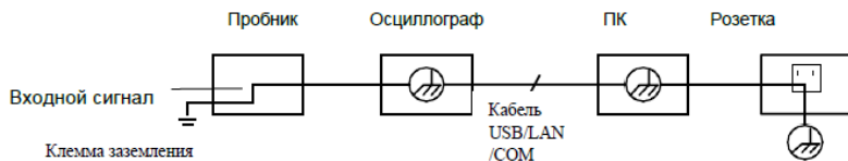
Рисунок 2 - Схема подключения заземляющего провода при подключении осциллографа к ПК
