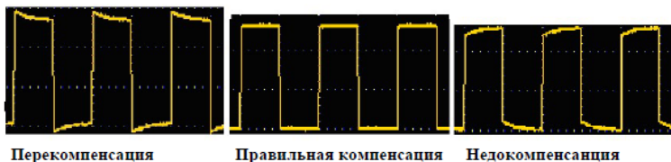
Рисунок 9 - Отображаемые формы сигналов при компенсации пробника
