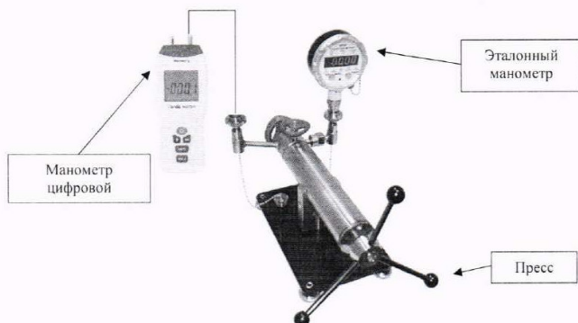
Рисунок 1 – Схема подключений при определении приведенной (к диапазону измерений) погрешности измерений избыточного и дифференциального давления манометра
