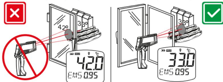
Прибор не может измерить температуру объекта находящегося за прозрачным или полупрозрачным препятствием, например: стекло, пар, дым и т.д. – он будет измерять температуру этого препятствия
