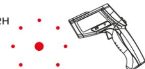
Диаметр круга приблизительно соответствует диаметру пятна измерения.
