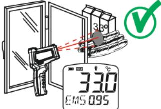
Прибор не может измерить температуру объекта находящегося за прозрачным или полупрозрачным препятствием, например: стекло, пар, дым и т.д. – он будет измерять температуру этого препятствия
